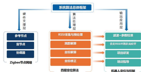
图1 双足机器人 Zigbee 定位系统算法总体架构图
